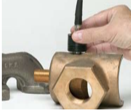
Zylinderbohrungen und viele andere Metallgussteile oder schallschwächende Werkstoffe können mit den 35HP-Geräten gemessen werden.
