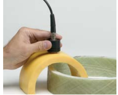
Die 35HP-Geräte eignen sich bestens zum Messen von Glasfaser oder Verbundwerkstoffen, deren Dicke kontrolliert werden soll, wie Strukturen in der Raum- und Luftfahrt, Schiffsrümpfe und Lagertanks.
