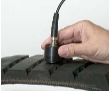
Messen der Tiefe bis zur Karkasse aus Cord oder Stahl bei Förderbändern oder Reifen
