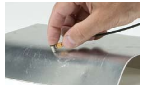
Das Gerät kann durch Biegen verursachte kritische Abnahme der Dicke von Metall messen.
