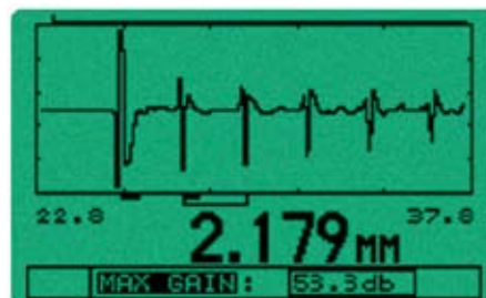
Mit dem als Option erhältlichen A-Bildmodus kann der Prüfer gleichzeitig Messwert und A-Bild anzeigen
