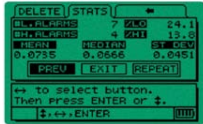
Statistik mit oberer und unterer Toleranzgrenze, mittlerer und Standardabweichung
